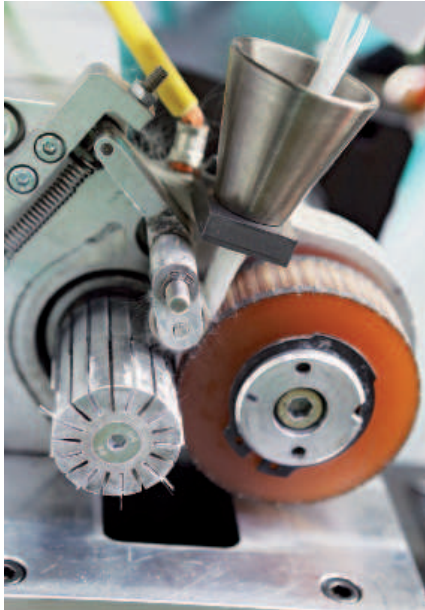
▲ Klingen schneiden auf einer rotierenden Walze die eingezogenen Fasern auf individuelle Länge.
