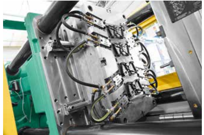
Bild 2. Die faserverstärkten Leichtbauteile entstehen in einem 4-fach-Werkzeug mit pneumatischem Nadelverschlussystem aus dem eigenen Formenbau von Ros (© Arburg)
