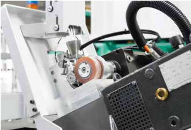
Bild 1. Die Glasfasern werden dem Prozess über eine Seitenbeschickung an der Maschine (Allrounder 630 S) zugeführt und in die PP-Schmelze geschnitten (© Arburg)
