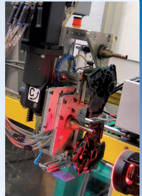
Duroplastproduktion – mit integrierter Kameraprüfung
